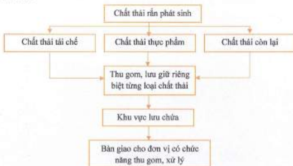
Hình 3. 14. Sơ đồ thu gom và quản lý chất thải rắn sinh hoạt
