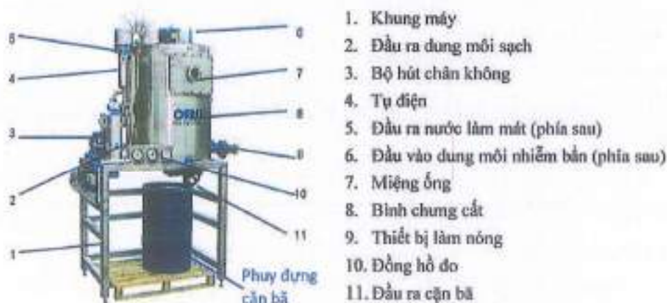
Hình 3. 13. Hình ảnh máy chưng cất dung môi OFRU (Máy B)
